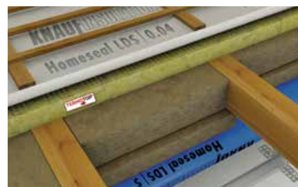
Skica 2 je opcija pri novogradnji oz. izdelavi podstrešja na novo. Pri tej varianti bi bila mogoča tudi izpeljanka z vidnimi špirovci.
